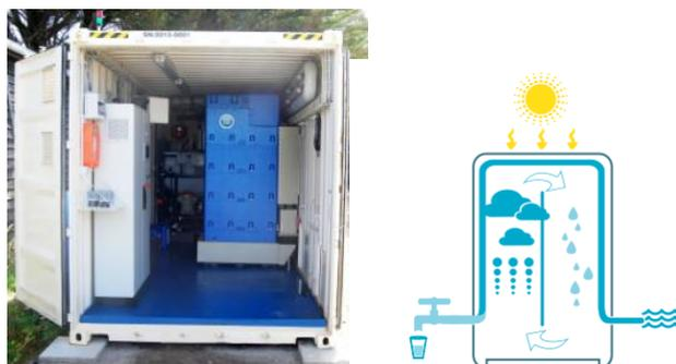
Ces produits utilisent la technologie « Multi Humidification - Déshumidification (MHD) » détenue par TMW, le résultat d'un effort capitalisé en R&D sur 10 ans. La MHD est basée sur l'évaporation à pression atmosphérique à basse température et permet de concentrer les matières polluantes dans un volume restreint ; la technologie TMW s'applique aux procédés industriels et permet à ses utilisateurs de :
