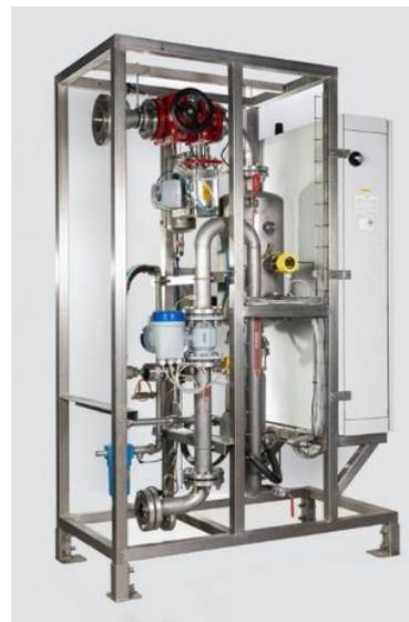
Cette technologie de rupture brevetée optimise le conditionnement des boues en modifiant, notamment, leurs caractéristiques physico-chimiques et rhéologiques. Grâce à cette technologie, une amélioration significative des performances globales de l'atelier boues est constatée, ainsi qu'une diminution du volume des boues à éliminer et un abaissement des coûts d'exploitation des stations d'épuration.
